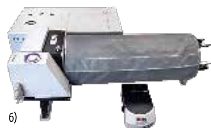
Рис. 1. Система для газового анализа на базе спектрометра ФТ-801 с многопроходной импортной газовой кюветой с оптическим ходом 20 м, высокочувствительным охлаждаемым МСТ-детектором без нагрева (а) и с нагревом (б)
