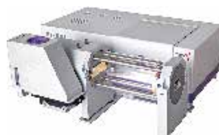
Рис. 2. Система для газового анализа на базе ФТ-801 с газовой кюветой (оптический ход 4,8 м) и охлаждаемым МСТ-детектором
