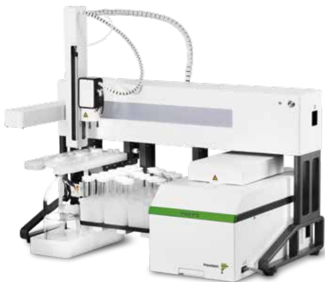
Рис. 7. Роботизированная система подготовки проб PreeKem PREPS
