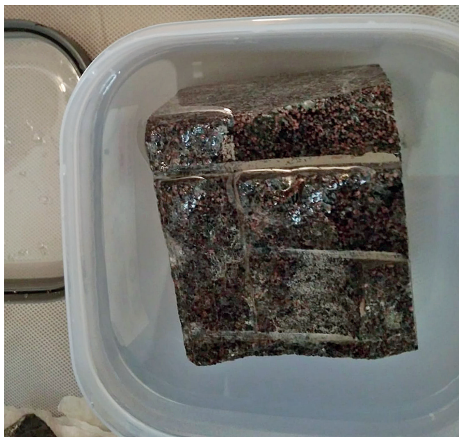
Рис. 5. Образец эклогита в полипропиленовом контейнере в растворе пентабората цезия. Размеры ~10×10×10 см
