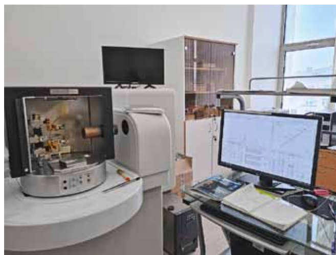
Рис. 7. Дуговой атомно-эмиссионный спектрометр «Гранд-Глобула» (ВМК «Оптоэлектроника», Россия)
