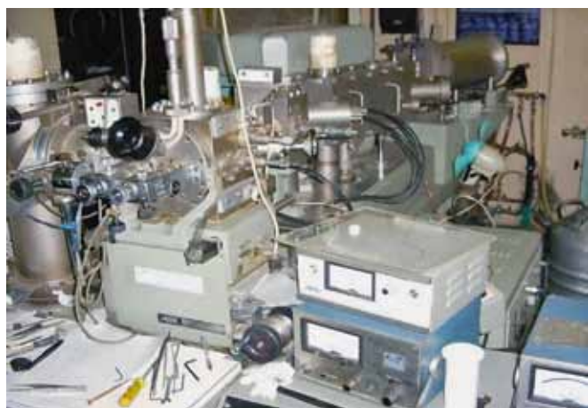
Рис. 2. Искровой масс-спектрометр с двойной фокусировкой (JEOL, Япония)
