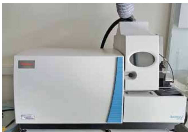
Рис. 5. Масс-спектрометр с индуктивно связанной плазмой XSeries II (Thermo Electron Corp., США)
