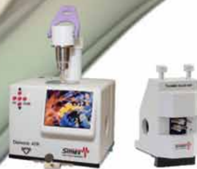
Приставки для экспресс-анализа твердых и жидких веществ: НПВО с алмазом и регулируемый жидкостной конденсор (РЖК)
