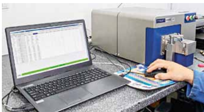
Искровой оптико-эмиссионный спектрометр Foundry-Master Smart (стенды компаний «Мелитэк», ИМС)
