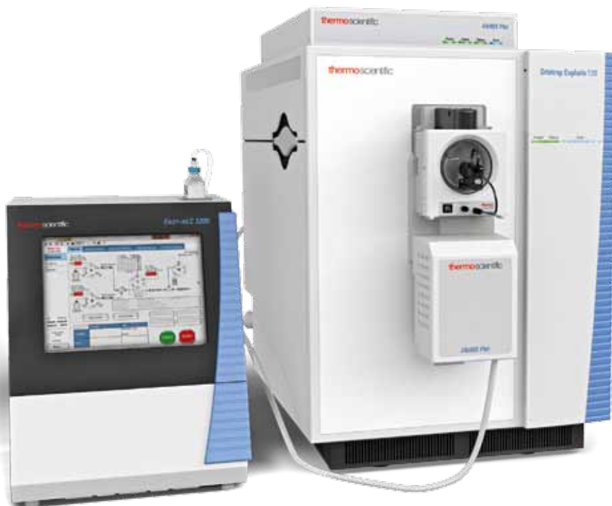
Thermo Scientific Orbitrap Exploris 120 – масс-спектрометр, соединенный с Easy nanoLC 1200 жидкостным хроматографом посредством источника ионов EasySpray и спектрометром ионной подвижности с асимметричным полем (FAIMS)
