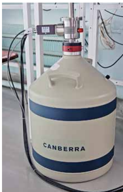
Сверхнизкоэнергетический гамма-спектрометр с германиевым детектором
