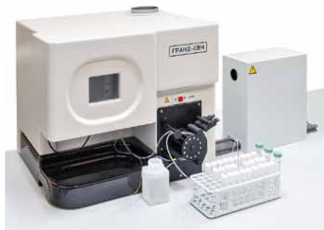
Рис. 1. Источник возбуждения спектров с микроволновой плазмой спектрометра «Гранд-СВЧ»
