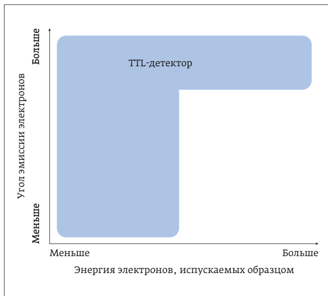
Рис. 6. Схема чувствительности TTL-детектора.
