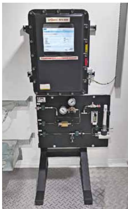
Аналитический блок промышленного хроматографа «Хромос ПГХ-1000» во взрывозащитной оболочке и система пробоотбора
