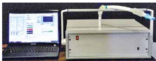
Рис. 4. ДЛС для диагностики выдыхаемого воздуха по биомаркерам: ^{12}CO_2 , ^{13}CO_2 , CH_4 , H_2S , NH_3 и H_2O
