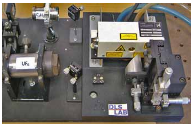
Рис. 3. Прототип прибора для измерения изотопического состава UF_6
