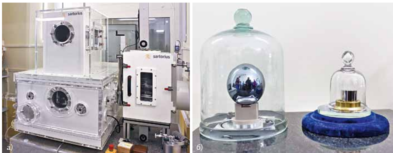
Рис.2. Составные части комплекса оборудования для вакуумного взвешивания: а) вакуумный компаратор массы CCL 1007 и вакуумная транспортная система; б) кремневая монокристаллическая сфера и национальная копия килограмма № 12
