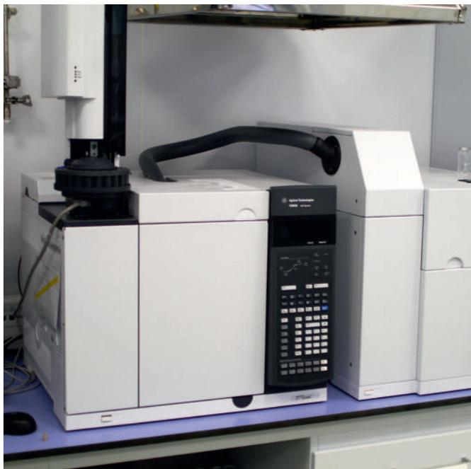
Газовый хроматограф Agilent 7890B с парофазным пробоотборником Agilent 7697A
