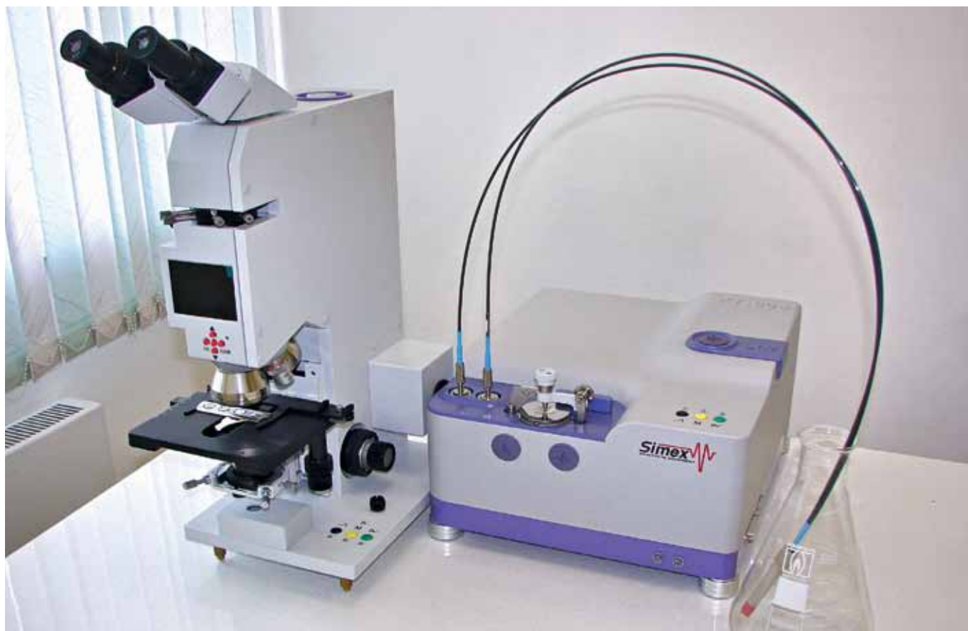
Рис.2. ИК-фурье-спектрометр ФТ-805 с микроскопом "МИКРАН-2" и петельным зондом
