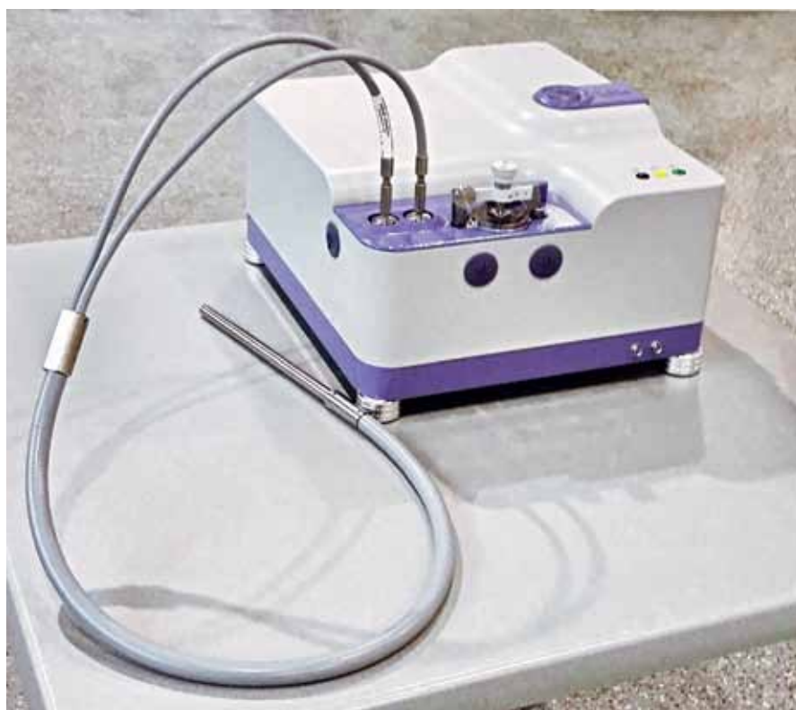
Рис.1. ИК-фурье-спектрометр ФТ-805 с оптоволоконным зондом с кристаллом НПВО
