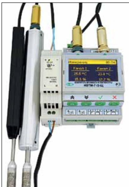
Рис.2. Стационарный термогигрометр ИВТМ-7/2-Щ
