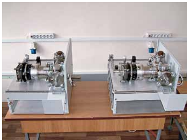
Два первых масс-спектрометра на начальном этапе сборки
