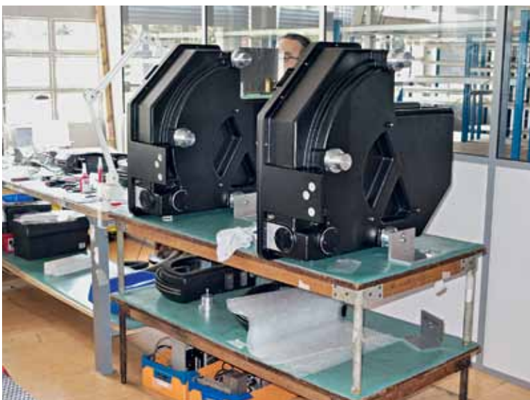
Проверка цельнолитых корпусов полихроматоров для систем GD-Profilер 2
