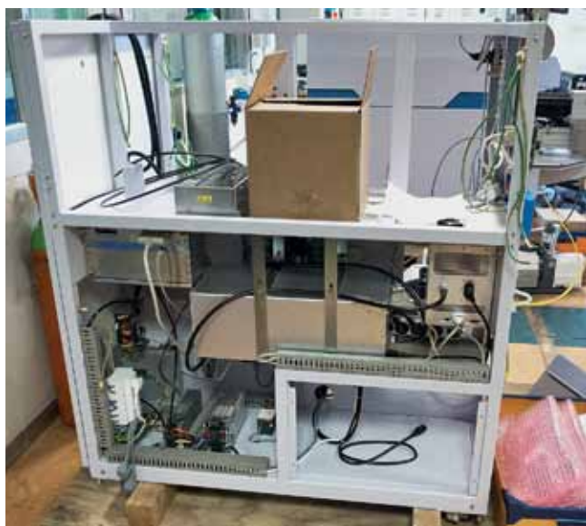
Монтаж системы GD-Profiler 2: слева – установка собирается из готовых блоков, справа – электронный блок системы управления
