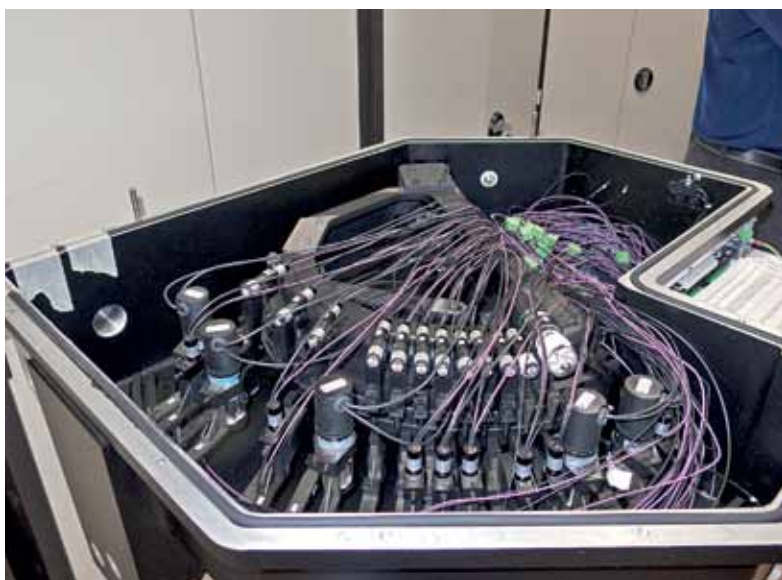
Полихроматор с установленными ФЭУ
