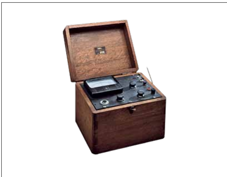
рН-метр, разработанный Масао Хориба, 1951 г.
