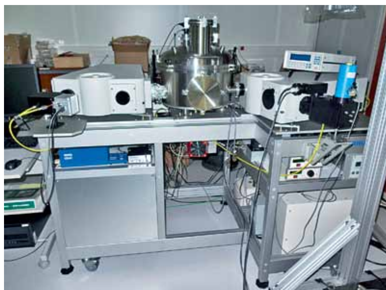
Уникальный спектрометр с двумя монохроматорами и вакуумной камерой
