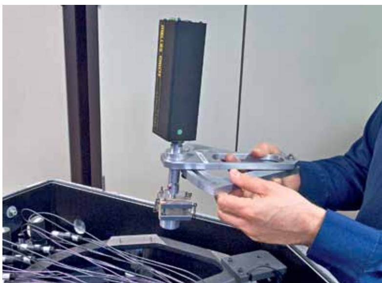
Простейшая система имитации отражения лучей от дифракционной решетки для точной настройки полихроматора
