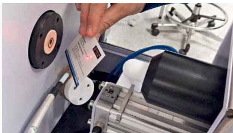
Собранная система GD-Profilier 2. Видны пятна двух лазерных лучей для определения глубины кратера на образце
