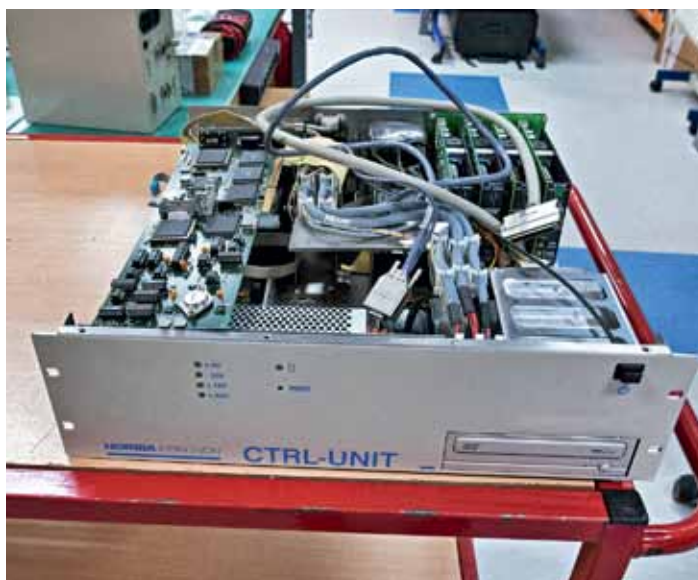
Монтаж системы GD-Profiler 2: слева – установка собирается из готовых блоков, справа – электронный блок системы управления
