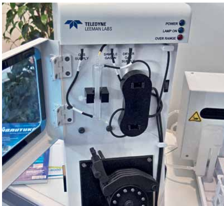
Реакционная зона QuickTrace M-7600
