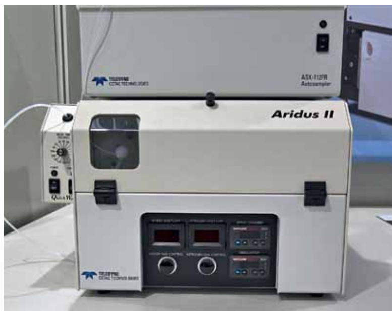
Система десольватации с нагревом Aridus II с автосамплером ASX-112FR
