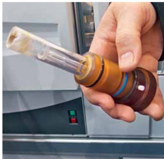
Демонтированная плазменная горелка
