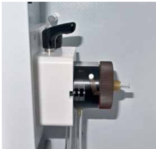
Юстировочная шкала и замок крепления плазменной горелки
