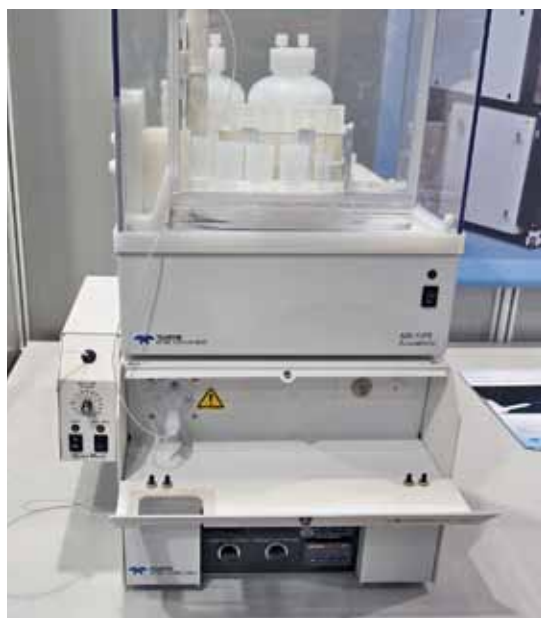
Система десольватации с нагревом Aridus II с автосамплером ASX-112FR
