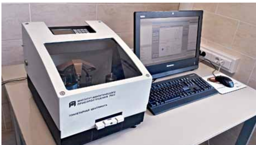
Планетарная центрифуга с вращающейся спиральной колонкой (ИАП РАН)
