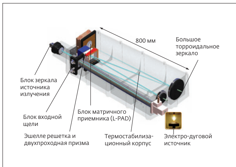
Схема длиннофокусного полихроматора Эшелле
