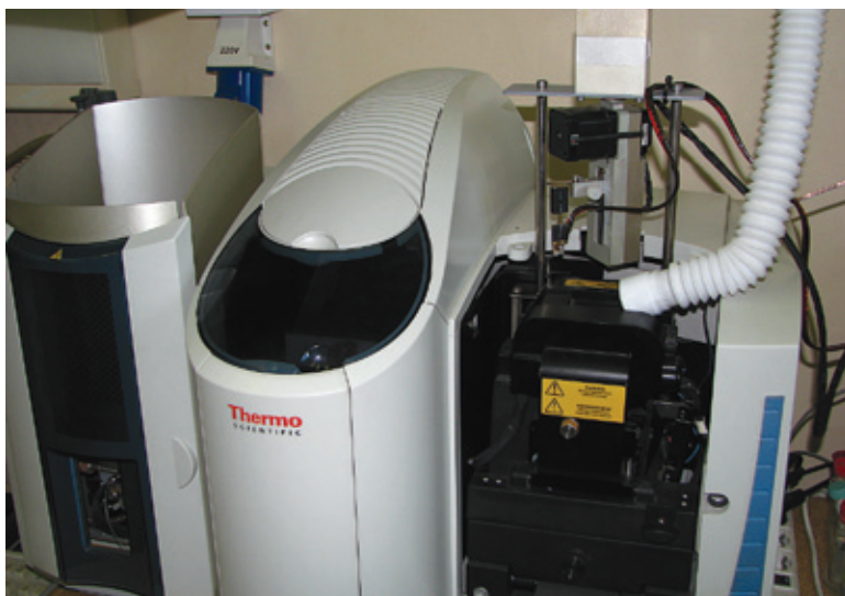
Варианты монтажа Атзонд-1 на атомно-адсорбционных спектрометрах
