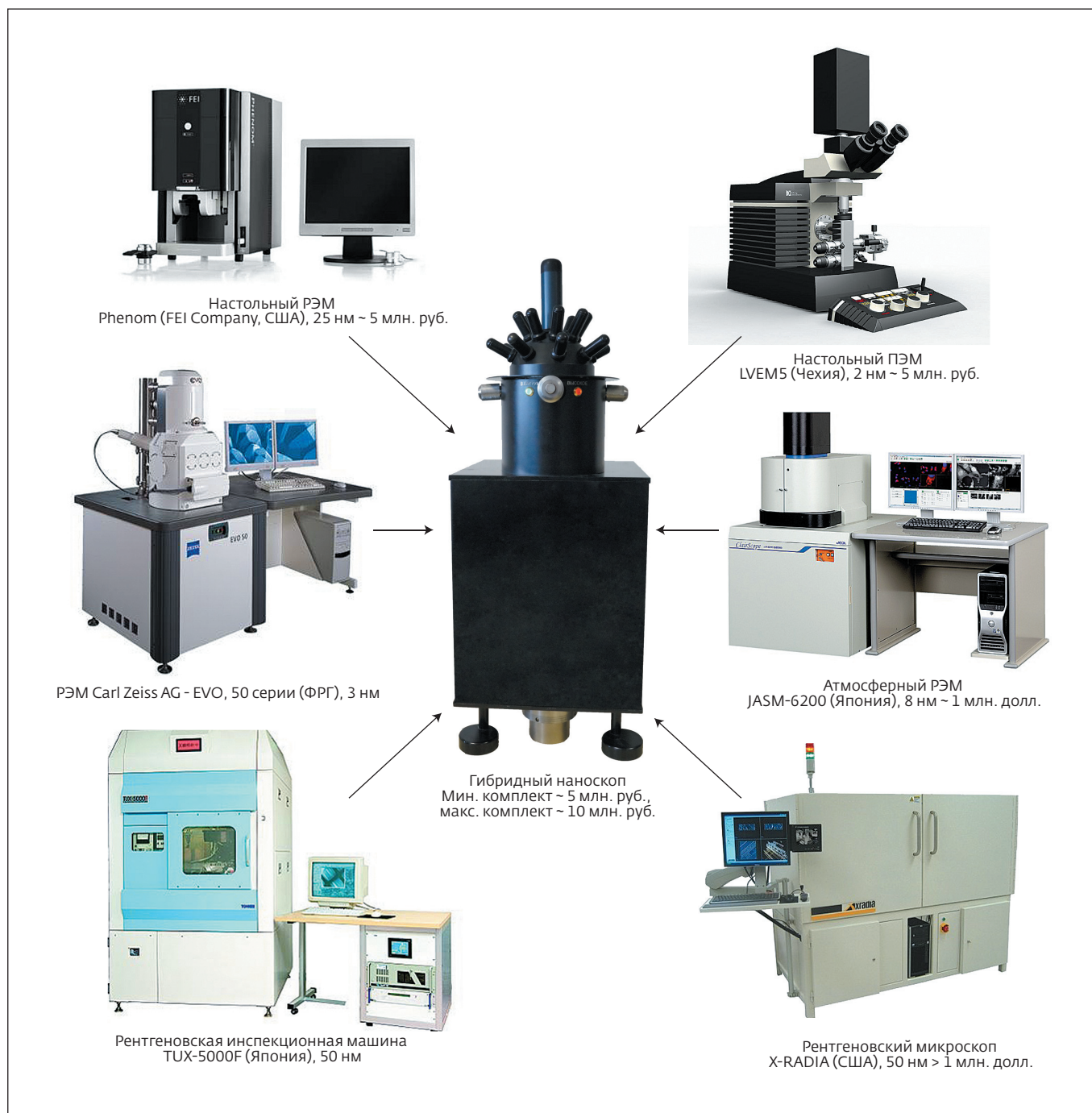
Рис.3. Гибридный наноскоп и приборы, которые он может заменить
