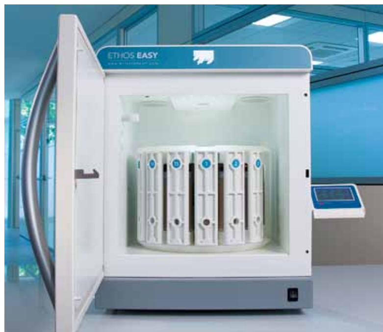
Камерная система кислотного автоклавирования Milestone ETHOS EASY с сегментным ротором SK-15
