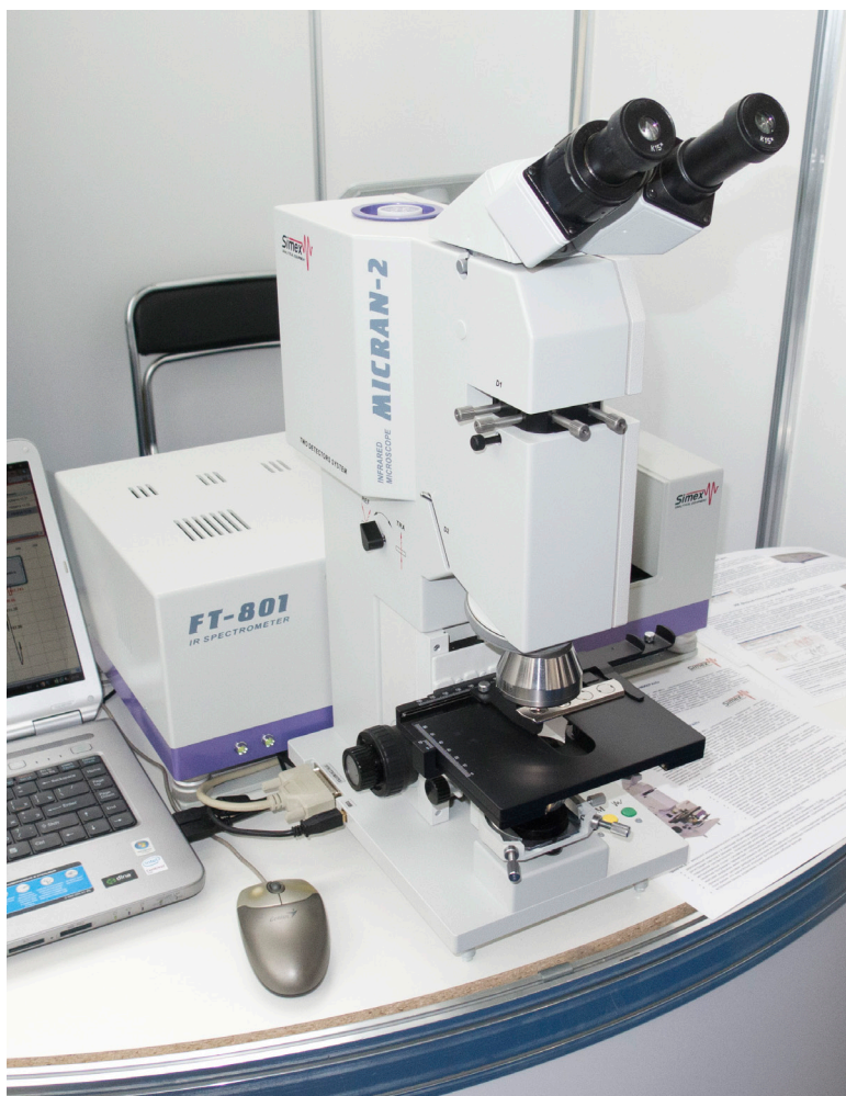
Спектральный комплекс: ИК-фурье-спектрометр ФТ-801 с ИК-микроскопом "МИКРАН-2"
