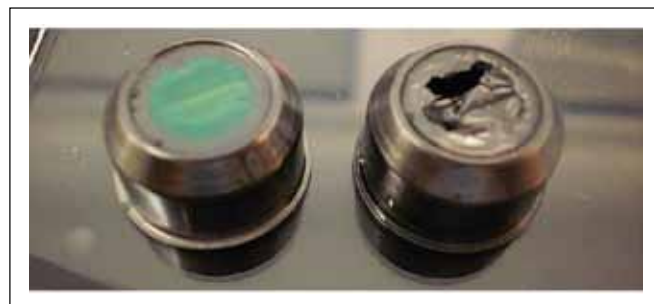
Рис.6. Окна DuraBeryllium и DuraBeryllium Plus после воздействия HCl около 3 ч
