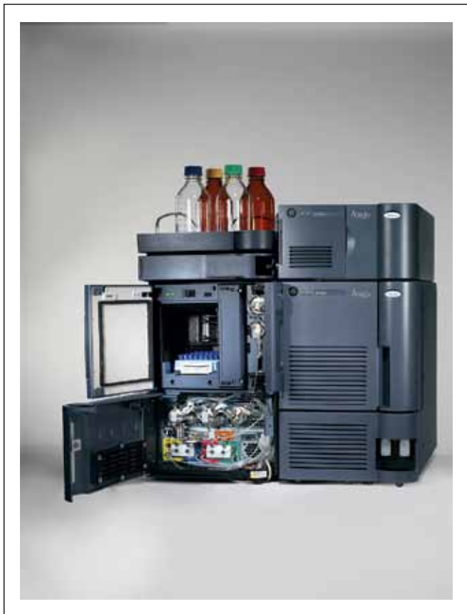
Рис.1. Один из приборов компании Waters для ультраскоростного хроматографического анализа – Acquity UPLC H class.
