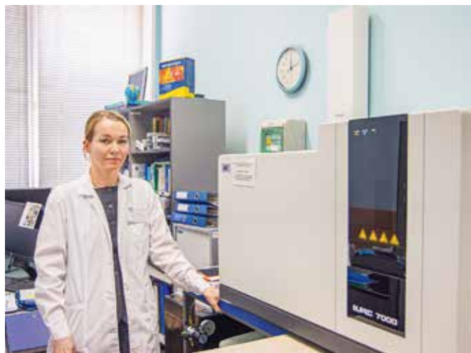
Рис. 3. Определение содержания металлов в объектах окружающей среды на масс-спектрометре с индуктивно связанной плазмой FPA Supes 7000 (КНР); заместитель начальника отдела физико-химических методов анализа Е. В. Рассказова
