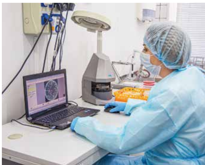
Рис. 10. Ведущий бактериолог Л. В. Бугаевская, курирующая систему внутреннего контроля сектора бактериологии и вирусологии, выполняет учет результатов контроля мембранных фильтров на электронном счетчике колоний
