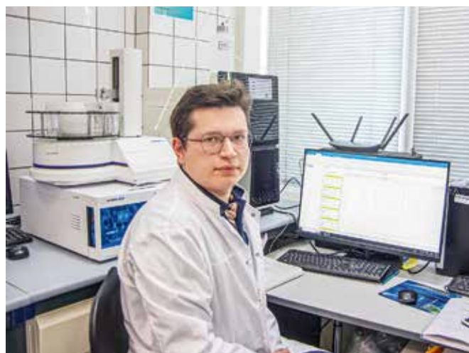
Рис. 2. Определение содержания анионов в воде на ионном хроматографе Shine CIC-D180, техник В. Н. Болсуновский
