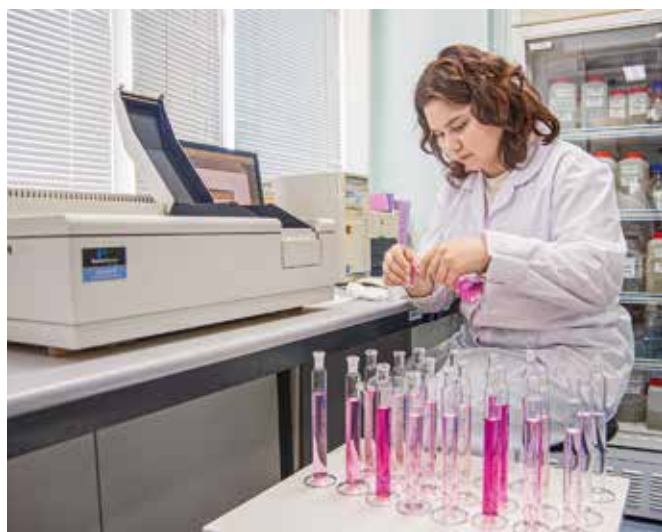
Рис. 4. Определение нитритов в воде на спектрофотометре LAMBDA; техник Л. Н. Гильмутдинова
