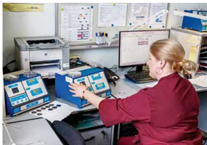
Рис. 5. Выполнение анализов на радиометре УМФ-2000, предназначенном для измерения суммарной активности альфа-бета излучающих нуклидов в счетных образцах проб объектов окружающей среды, в том числе водных; инженер 1-й категории А. Д. Семичастнова
