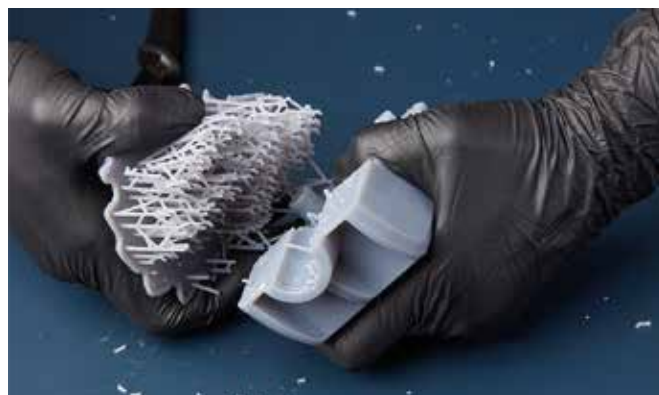
Рис. 1. Постобработка готового изделия, удаление «поддержек» [5]
