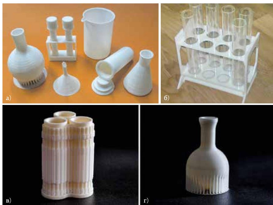
Рис. 3. Лабораторное оборудование, изготовленное методом FDM: а – круглая и коническая колбы, воронка, химический стакан, пробирки различных размеров; б – подставка под пробирки [24], в – подставка для трех пробирок, г – круглодонная колба, на «поддержках» [25]
