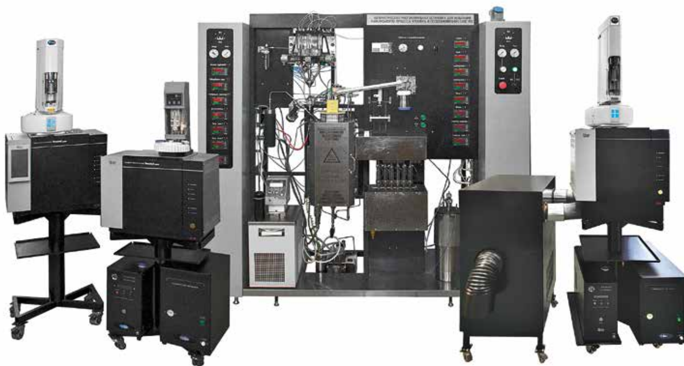
Рис. 1. Многоканальная установка для оценки активности катализаторов флюид-каталитического крекинга (FCC) в псевдооживленном слое согласно ASTM D7964/D7964M-19 (ACE)
