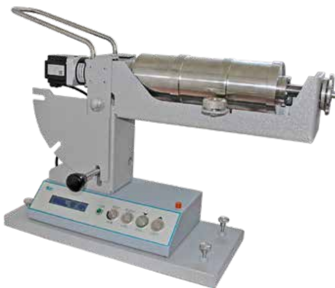
Рис. 9. Прибор для испытания на трение и истирание катализаторов «ПТИ-2» с насадкой для метода по ГОСТ 16188-70
