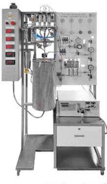
Рис. 10. Автоматическая шестиканальная установка для определения индекса оксида углерода
