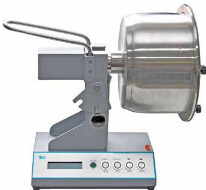
Рис. 7. Прибор для испытания на трение и истирание катализаторов «ПТИ-1» с насадкой для метода ASTM D4058-96
