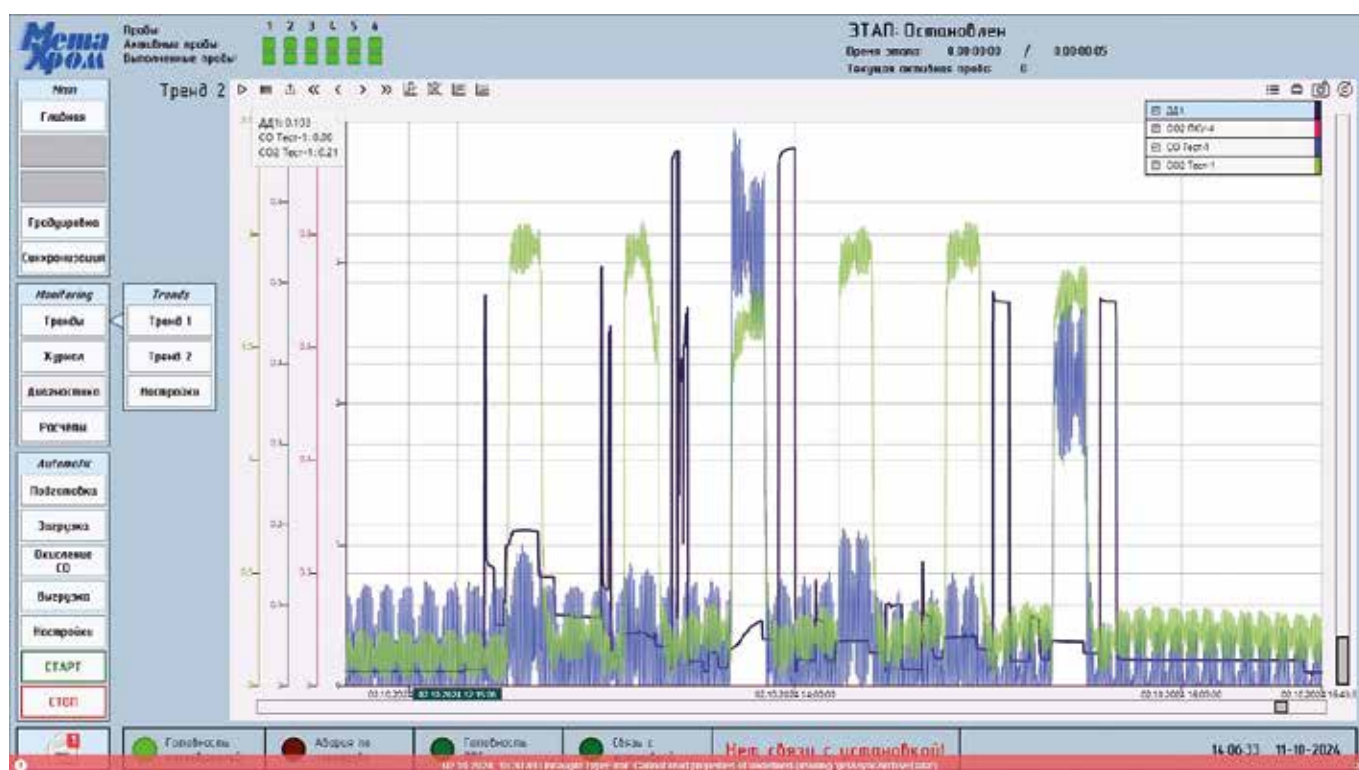
Рис. 11. График отображения компонентов газовой смеси и показаний давления на выходе из реактора: ось X – время, ось Y – измеренное значение
