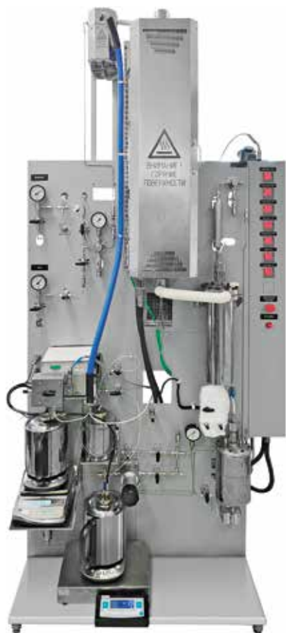
Одноканальная установка гидроочистки нефтяных фракций для снижения концентрации серо- и азотосодержащих соединений в товарных нефтепродуктах
