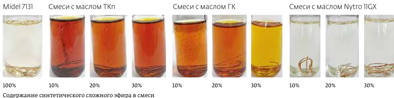
Рис. 3. Внешний вид эфиромасляных смесей после продолжительного термического старения
