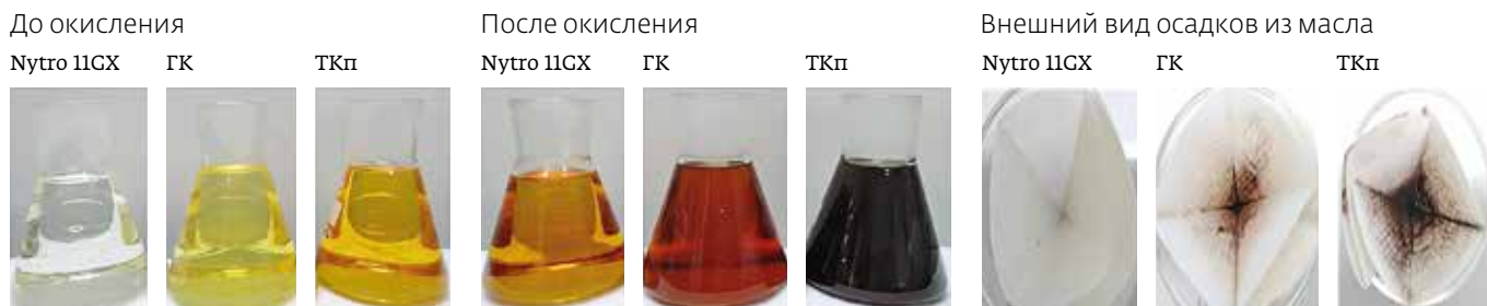
Рис. 2. Внешний вид масла до и после продолжительного термического старения и образовавшихся осадков
