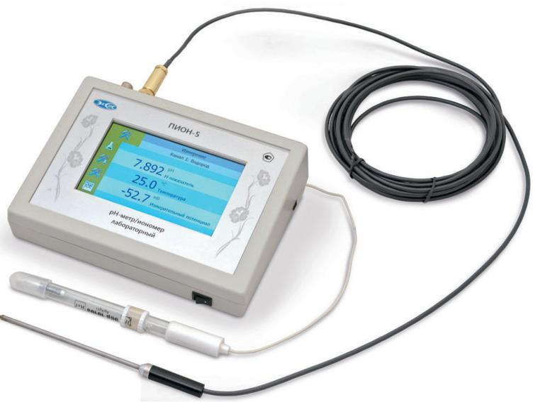
позволяют выполнять измерения от одного до четырех параметров одновременно в одном и том же или в разных растворах.
