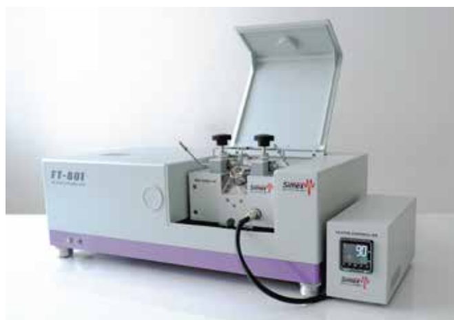
Рис. 2. Приставка парофазного анализа жидкостей в фурье-спектрометре ФТ-801. Рядом с прибором контроллер температуры (нагрев рабочего объема приставки – до 220 °С, точность 1 °С)
