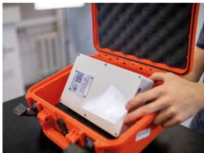
Рис. 2. Мобильный диагностический комплекс на базе портативного газового хроматографа «ПИА»
