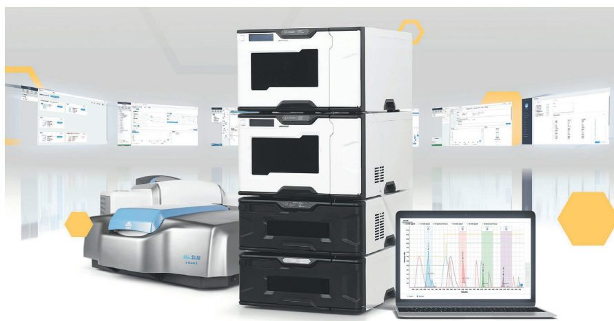
Рис. 1. Аналитический комплекс под управлением ПО Space CDS
