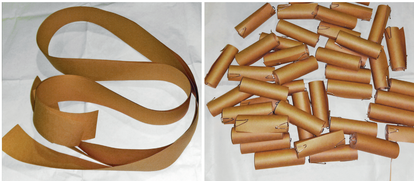
Рис. 1. Кабельная бумага К-120 (а) и рулоны из этой бумаги (б)
