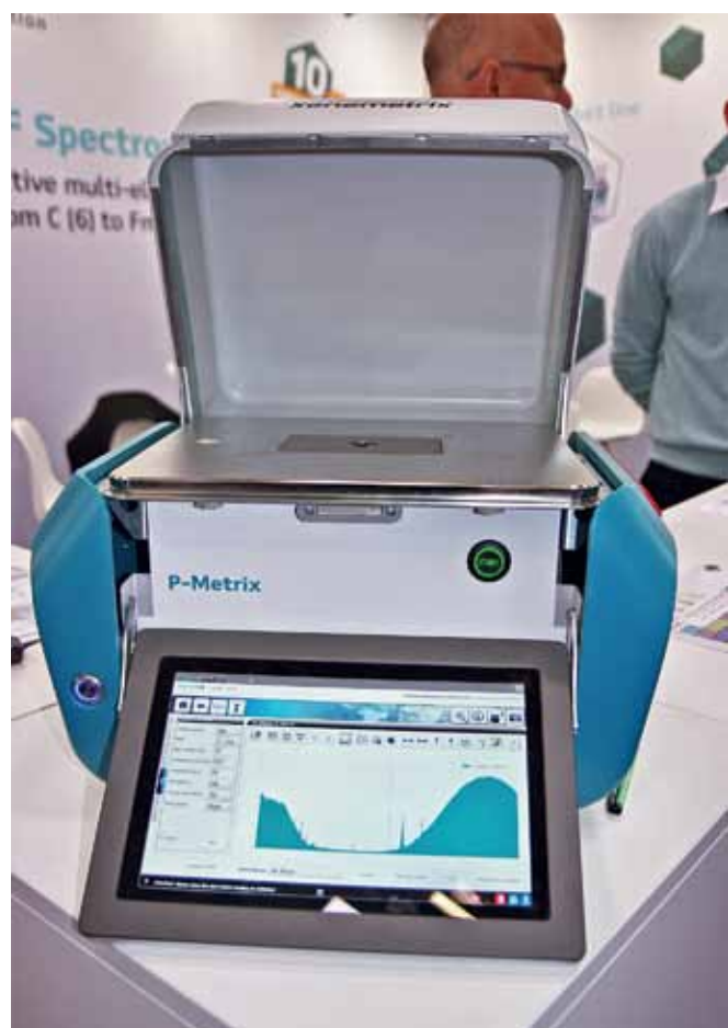
P-Metrix обладает мини-камерой для позиционирования образца и большим кюветным отделением
