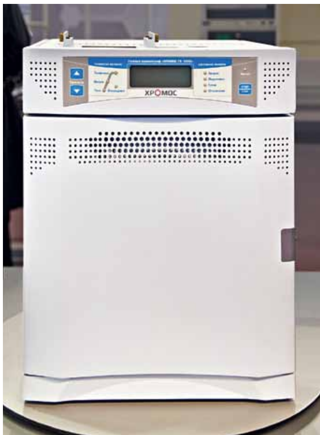
Газовый хроматограф "Хромос GX-1000" с уменьшенным термостатом колонок
