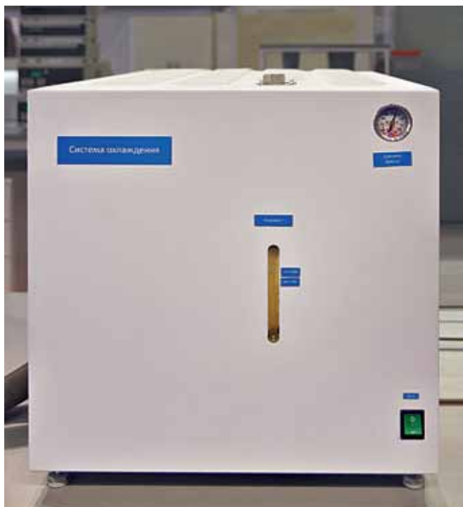
Система охлаждения термостата колонок
