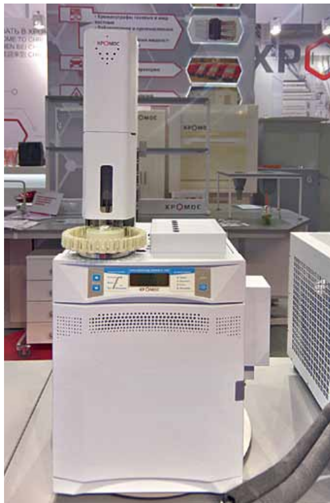
Газовый хроматограф "Хромос GX-1000" с автоматическим жидкостным дозатором "Хромос ДАЖ-23"
