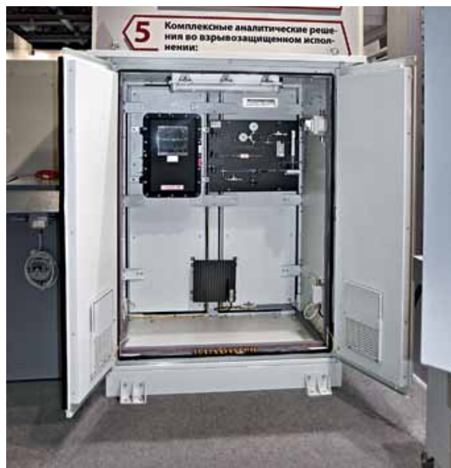
Промышленный газовый хроматограф "Хромос ПГХ-1000" во взрывозащищенном исполнении
